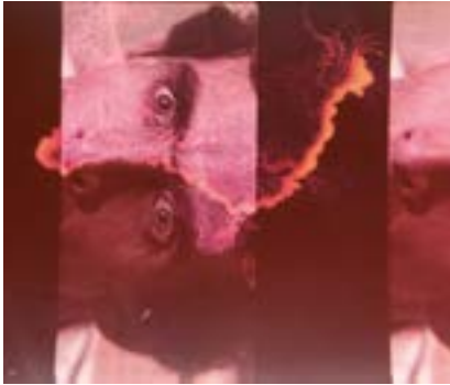
Filme visto por transparência, em que os fungos chegaram a afetar a imagem
