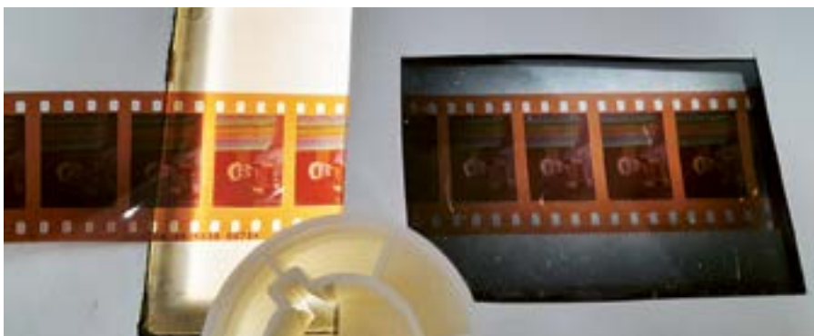
Acima, teste de polarização feito em filme de poliéster. Abaixo, em filme de acetato
