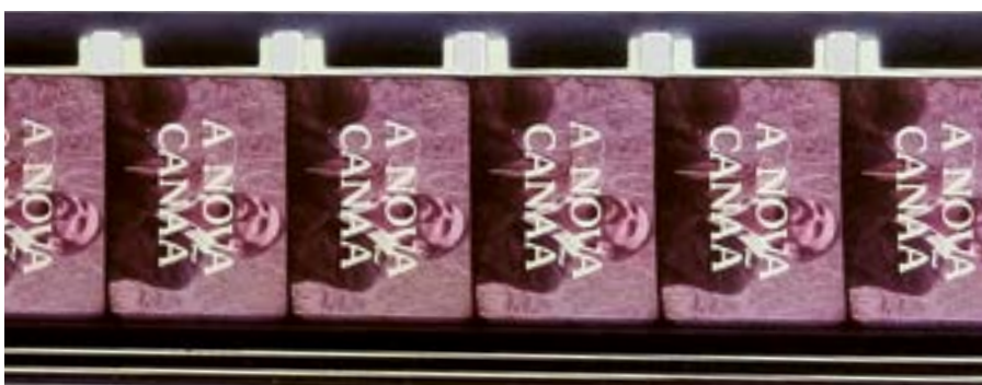
Filme colorido severamente descorado
