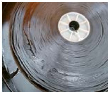
Degradação do suporte de acetato, filme melado
