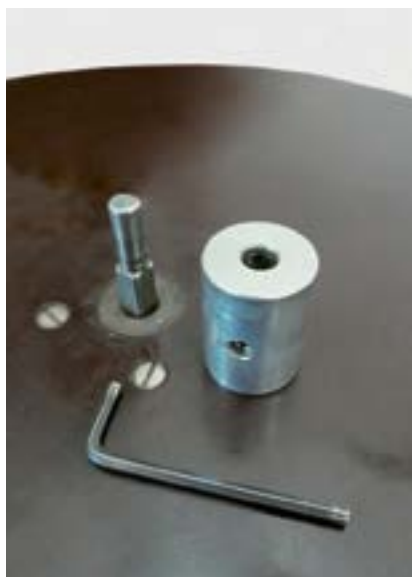
Pode ser útil retirar o pino da mesa enroladeira antes de remover o rolo, caso o modelo de mesa permita
