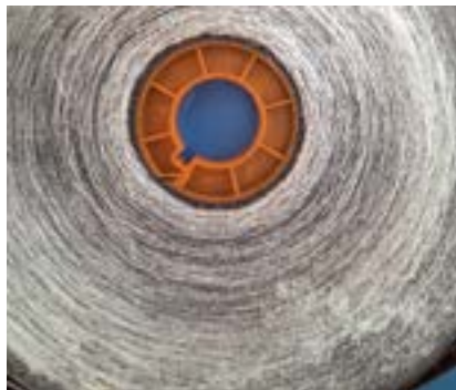
Filme em suporte de acetato cristalizado
