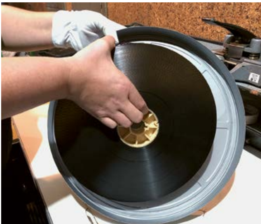
Método comumente usado para retirar o filme da lata ou do estojo
