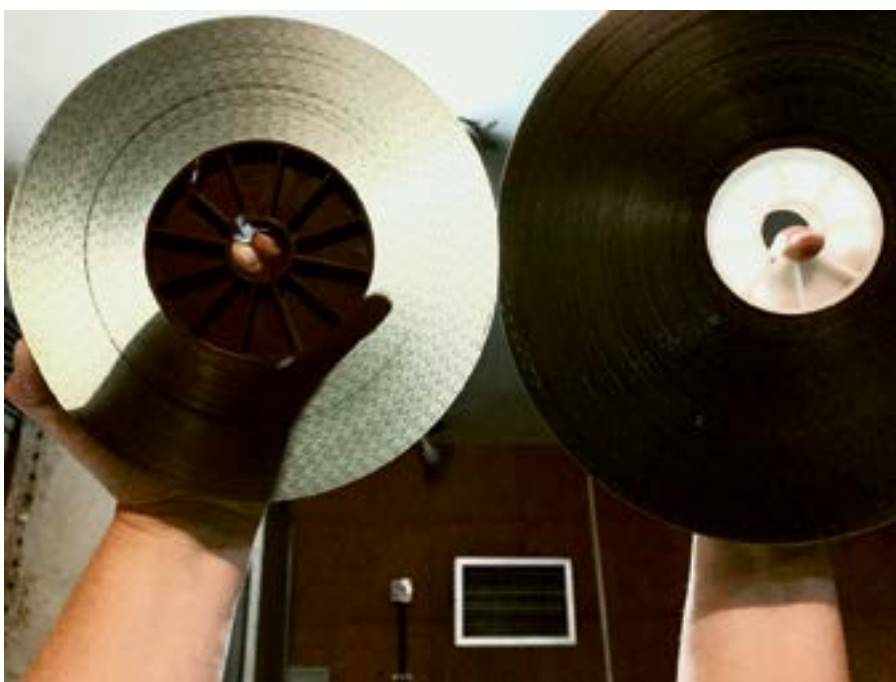
Um rolo de poliéster e um rolo de acetato, vistos em contraluz
