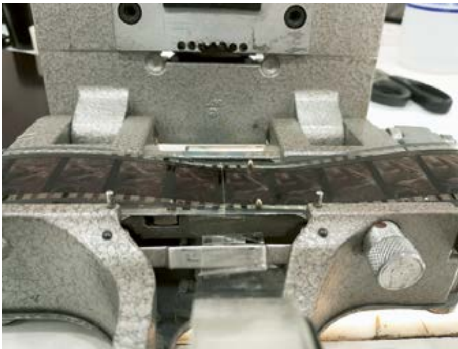
Ao não conseguir encaixar o trecho com emenda na coladeira, averiguamos que ela não está em bom estado, ou seja, a distância entre as perfurações não está sendo respeitada
