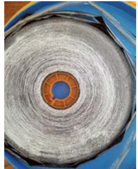
Embora o filme esteja degradado, não reagiu com o estojo de plástico inerte
