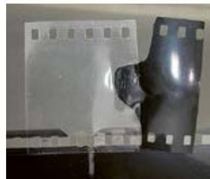
Primeiro fixamos a fita perfurada de um dos lados
