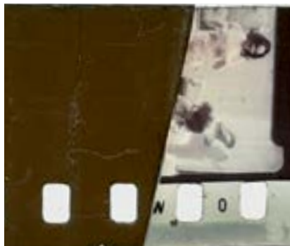
No alto, emenda de fita adesiva em uma cópia combinada e, acima, em um magnético perfurado
