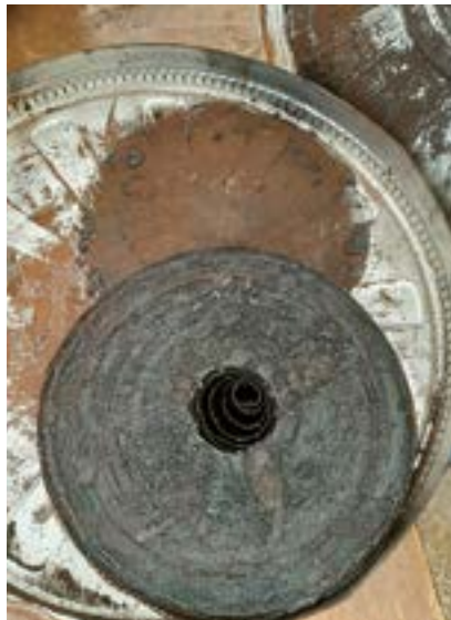
A lata enferrujada reage com o filme, acelerando sua degradação
