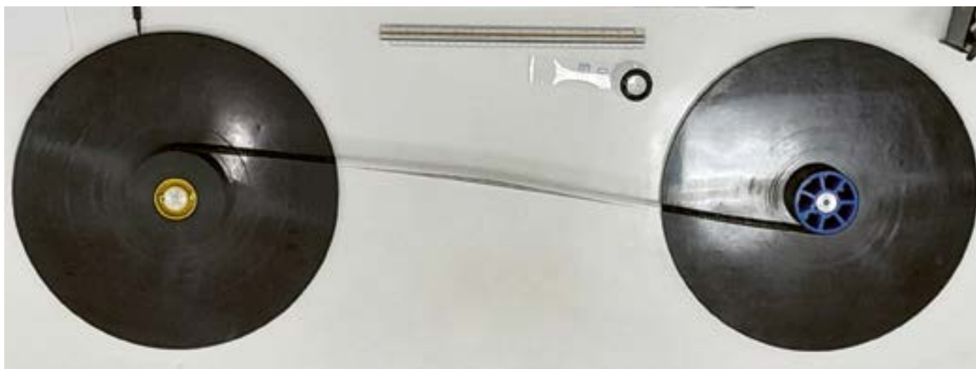
Forma como um filme é enrolado quando queremos inverter o lado da emulsão
