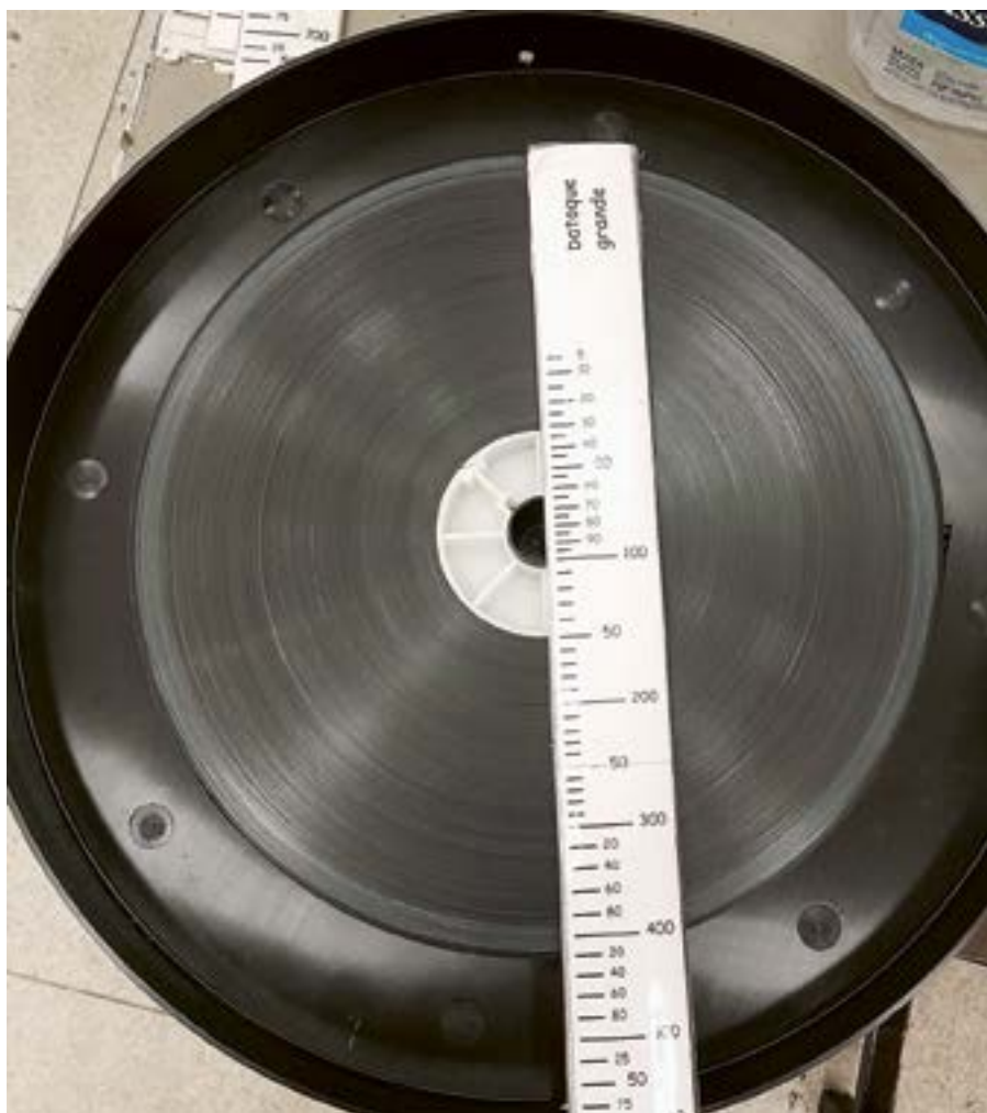
Medição aproximada da metragem do filme com uma régua de medição
