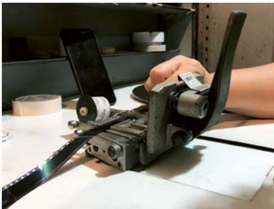
Ao realizar emendas de fita adesiva em filmes 16mm, é preciso virar a coladeira de ponta-cabeça para colocar a fita no verso
