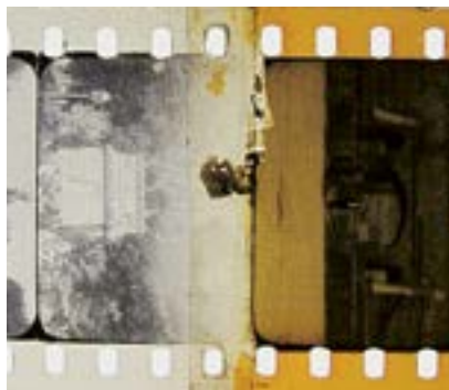
Emendas de cola originais do período silencioso geralmente são mais grossas e não se limitam ao espaço entre perfurações
