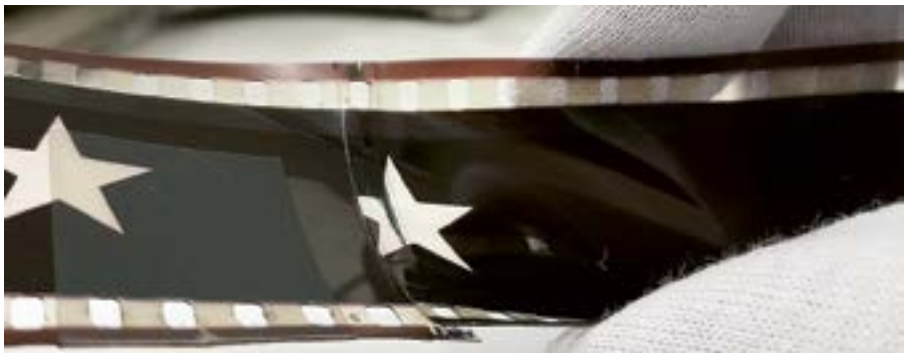
Emenda de cola em mau estado
