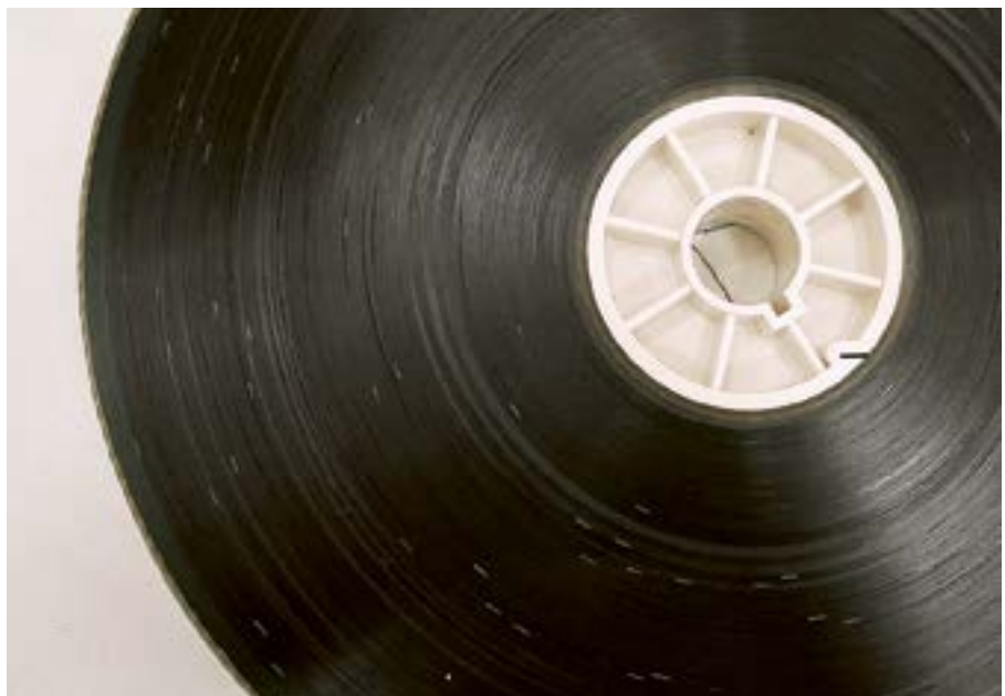
Por causa da sobreposição necessária às emendas de cola, é possível notá-las antes mesmo de abrir o rolo
